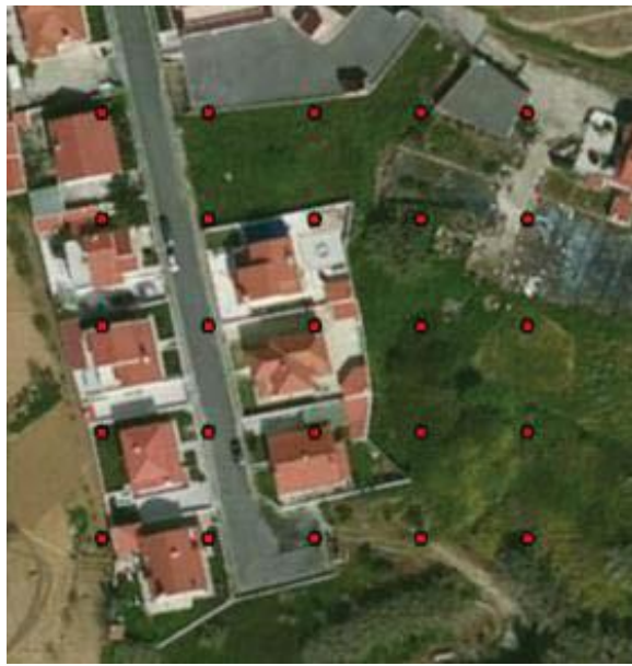
Obrázok 6 Príklad jedného pixelu s rozmermi 100 × 100 m s 5 × 5 bodmi s 20 m rozostúpením (Zdroj: Sannier a kol. 2016)
