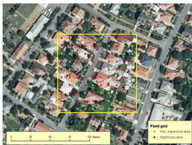
Obrázok 2 Vizuálna interpretácia bodov vo vzorke 100 x 100 m (Zdroj: Maucha a Büttner 2008)
